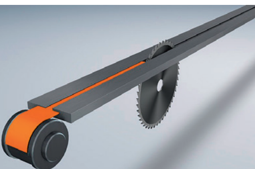
Fechamento da ranhura de corte patenteado, criado pela Raimann
