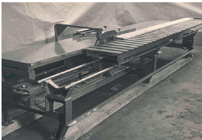
A origem da serra de corte circular longitudinal: A serra de carro de 1947 era muito semelhante às serras de mesa corrediças atuais
